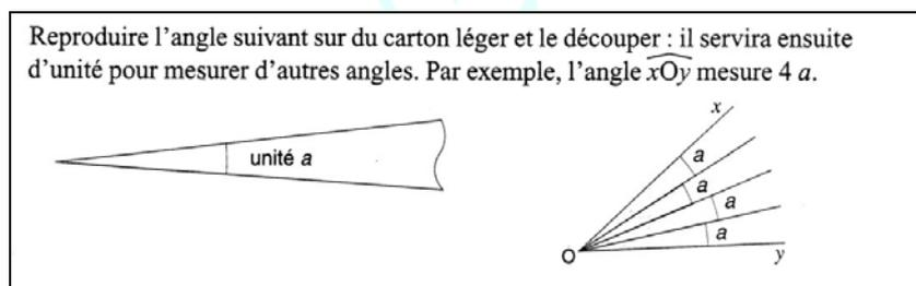
**figure 6.** Juxtaposition d'un gabarit unité pour mesurer des angles
